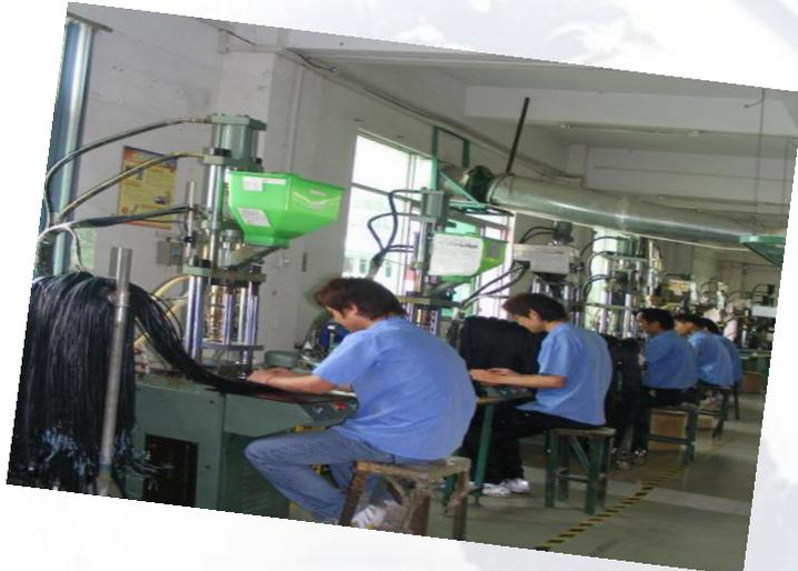
**工厂配置** cable立式数控成型机
